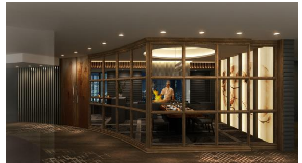
廊下側から見通せるクリアガラスが、個室使用時には不透明になる「プライバシーガラス」を採用(イメージ画)
